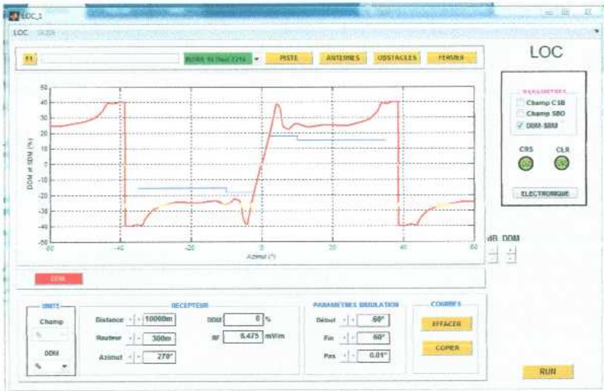
Fig 4.15 : DDM du réseau INDRA 16 antennes
