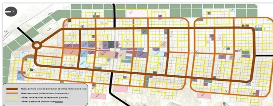
Figure III-27 : Hiérarchisation du réseau viaire de la ville nouvelle d'EL MENEAA
