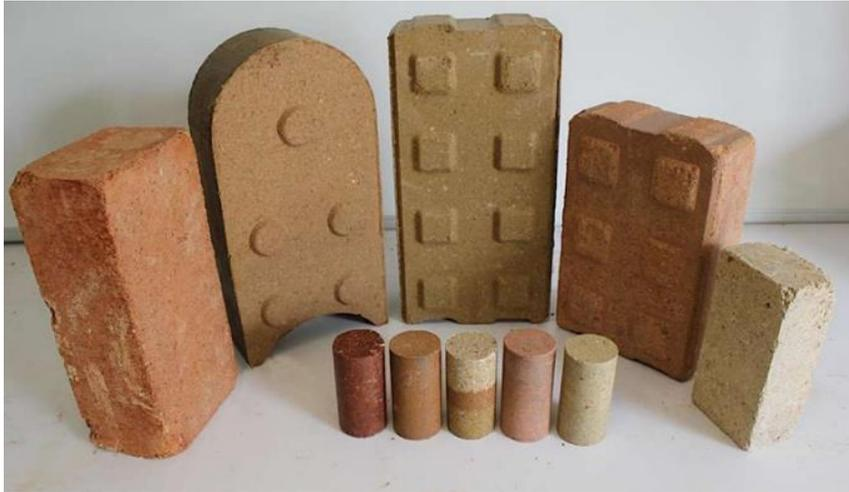
Figure III.58 : Brique de terre compressée. Source : <https://www.futura-sciences.com/maison/definitions/construction-maison-brique-btc-17851/>
