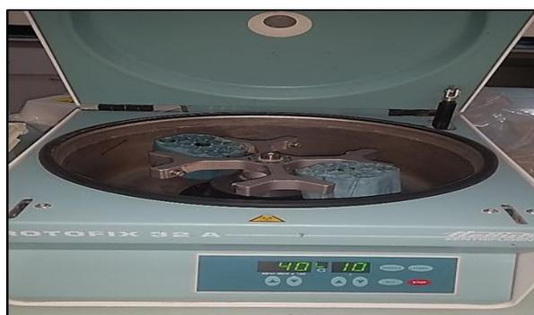
**FIGURE 33** CENTRIFUGEUSE REFRIGERER
