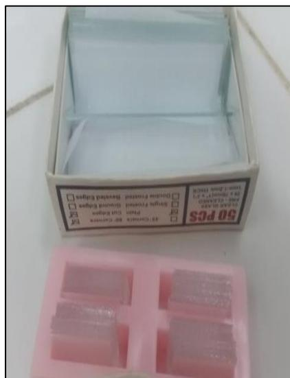
FIGURE 6 LAMES ET LAMELLES
