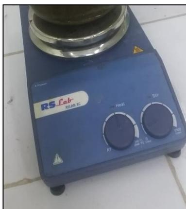
FIGURE 9 PLAQUE CHAUFFANTE ET AGITATEUR
