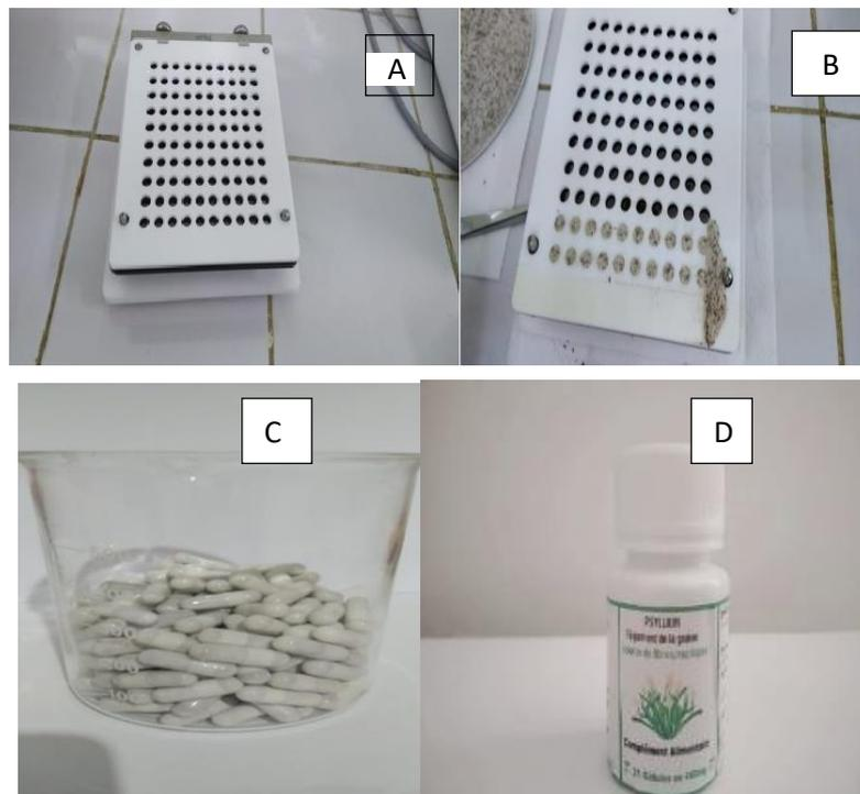
**Figure 19** : Le remplissage des gélules avec un gélulier manuel
