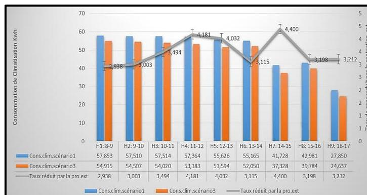
Figure 48: L'influence de la protection solaire extérieure sur les charges de climatisation pour la journée du 9 juillet (de 8h à 17h).
