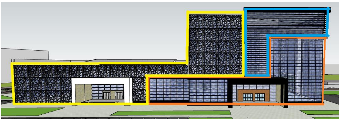
Figure 79: brise soleil (source: auteur)
