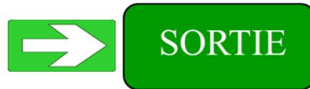
Eclairage de sécurité du type b : dans le cas d’une batterie ou d’un groupe, les lampes d’éclairage de sécurité doivent être alimentées en permanence pendant la présence du public et à l’état de veille, la puissance qu’elles absorbent doit provenir de la source d’éclairage normal.
