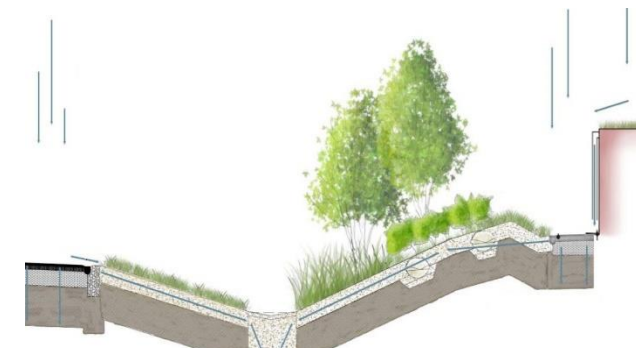
Figure 64 : schéma de capture des eaux, source : mémoire fin d'étude
