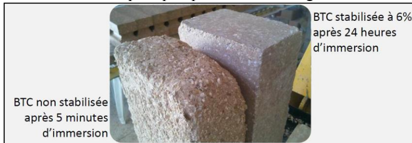
Figure 82 : différence entre un BTC stabilisée et non stabilisée Source : http://craterre.org
