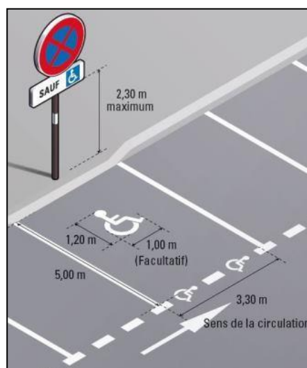
Figure 88 : place stationnement PMR source signastore.fr
