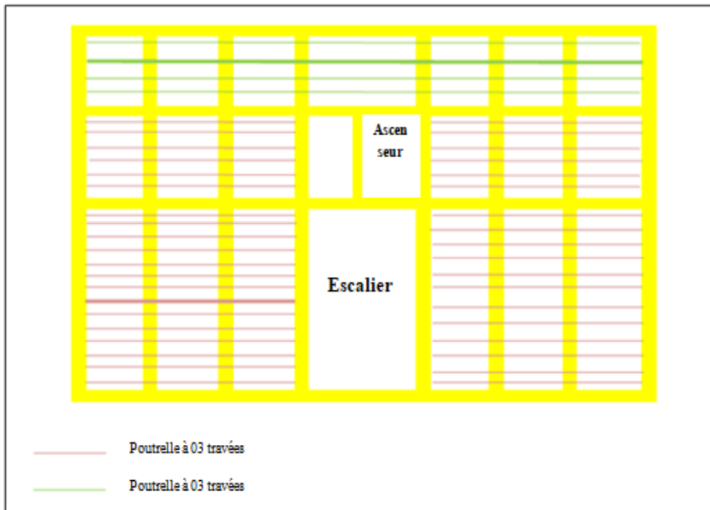
Figure III.8: Les types des poutrelles
