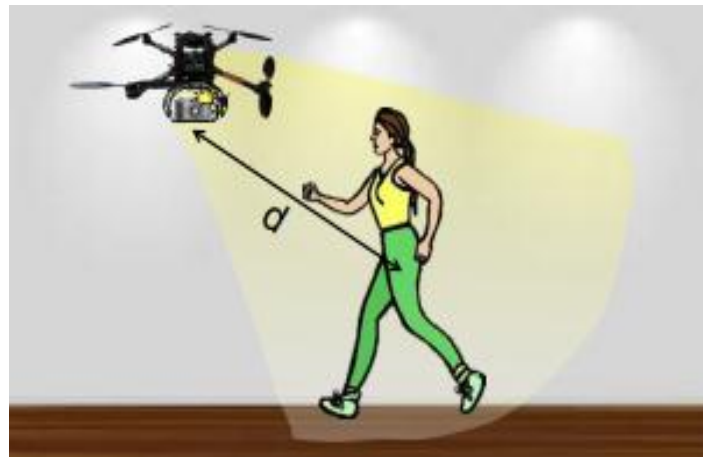
Figure II.6 Un exemple de système de suivi par Wi-Fi : le drone garde une distance fixe entre lui et l'appareil porté par l'utilisateur, tout en capturant une vidéo [9].
