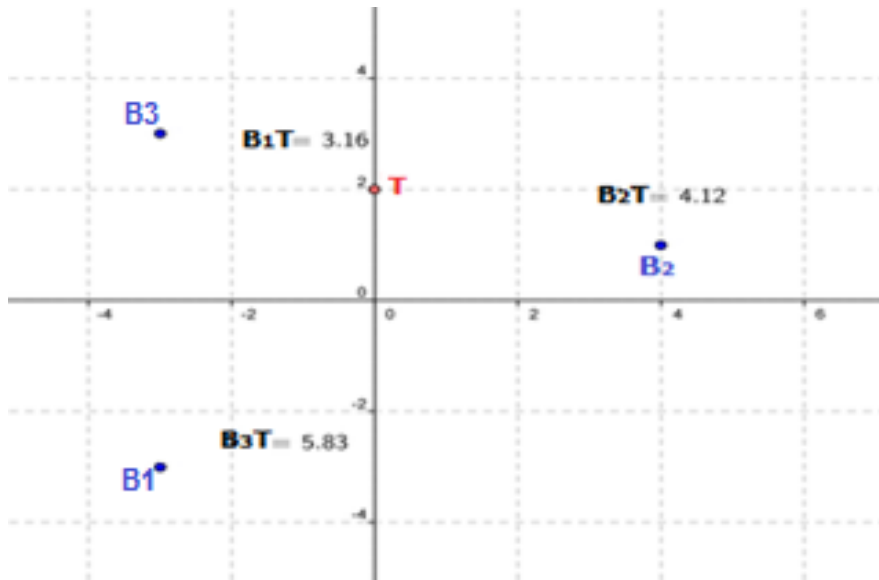
Figure II.10 Localisation par mesure de distances de trois balises.
