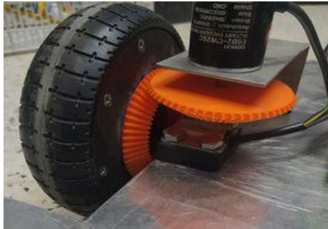
Figure III.21 Le placement finale de l'encodeur sur le châssis.
