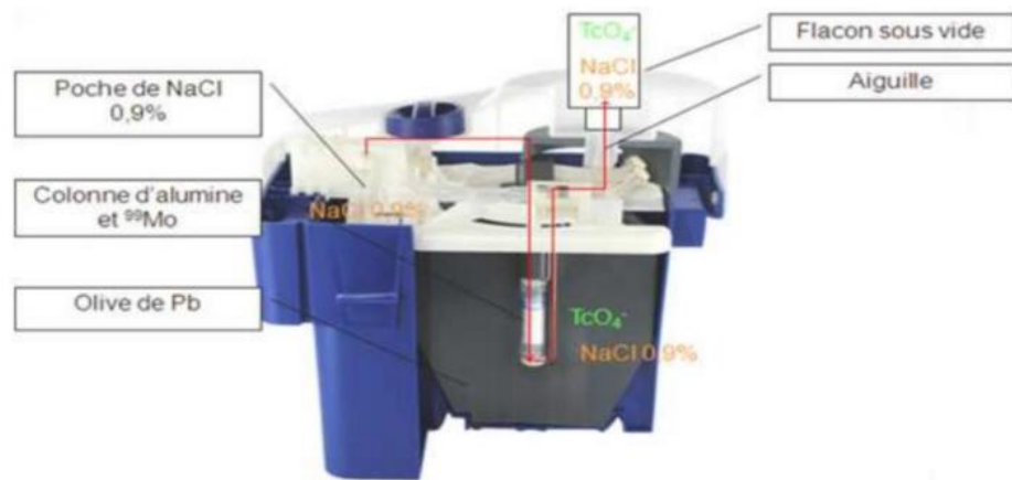
Figure 19 : Principe de générateur de ^{99}\text{Mo} - ^{99\text{m}}\text{Tc} . (113)
