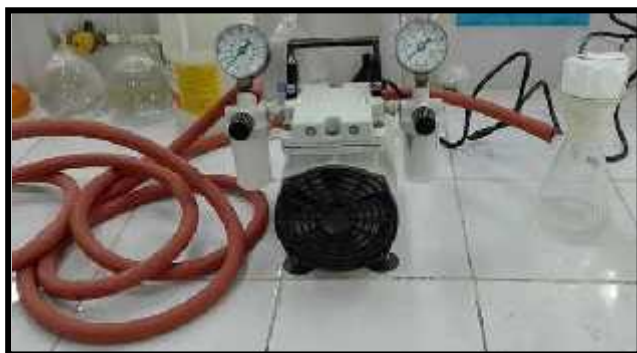
Figure 06 : Dispositif de filtration sous pression réduite.
