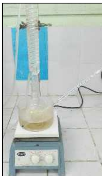
Figure 32 : Chauffage à reflux du mélange après l'ajout de l'anhydride acétique.
