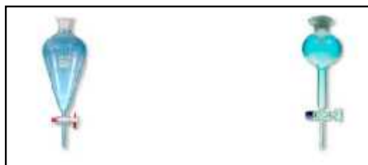
Figure 24 : Les différents types d'ampoules à décanter. [53]
