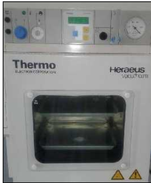
Figure 42 : Verre de montre contenant le paracétamol mis à l'étuve à 105 °C.
