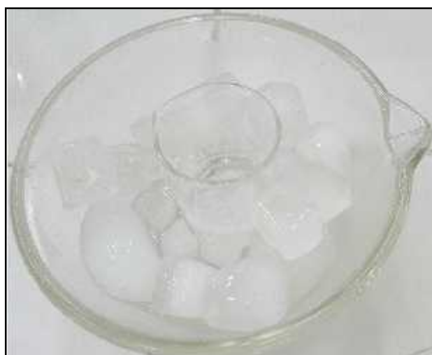
Figure 38 : Recristallisation du paracétamol dans un bain d'eau glacée.
