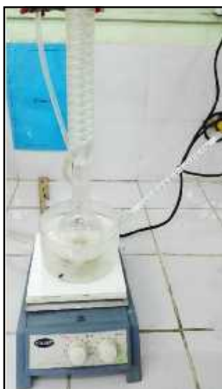
Figure 30 : Chauffage à reflux du mélange réactionnel.
