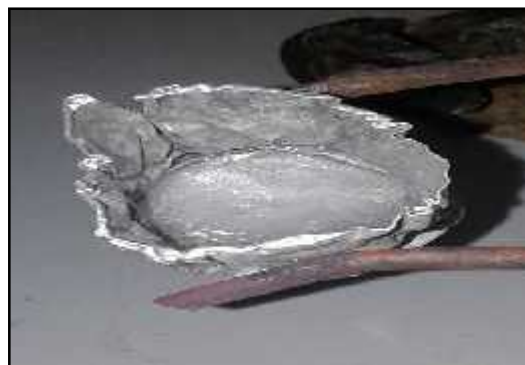
Figure 43 : Le creuset de platine après calcination du paracétamol.
