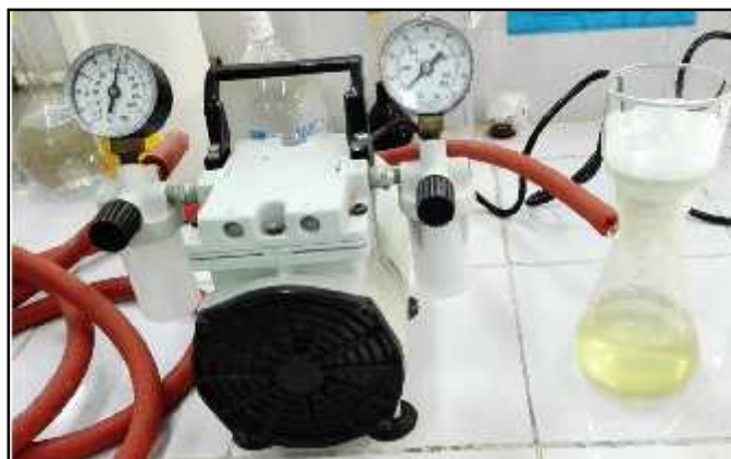
Figure 35 : Filtration des cristaux sur filtre Büchner à l'aide d'un dispositif de filtration sous pression réduite.
