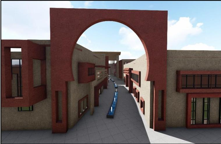
**Brise soleil :** On a utilisé des brises soleils et des ouverture brisé qui permet de protéger la façade, de l'exposition solaire pour éviter la surchauffe
