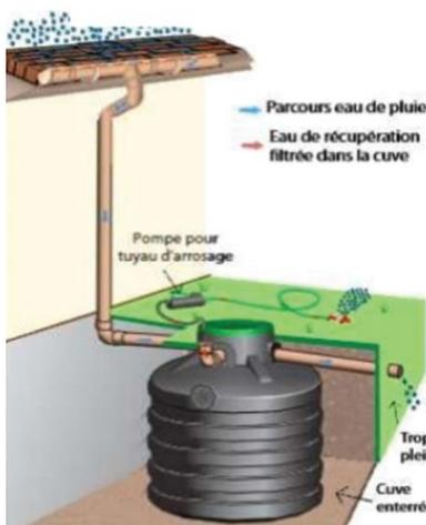
Figure -867- système de récupération des eaux pluviales
