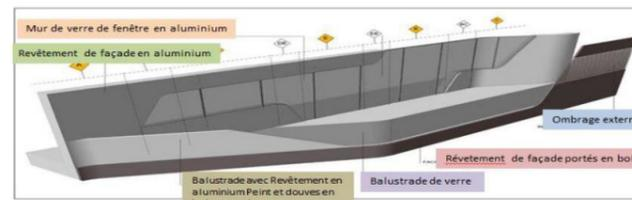
Figure- 29- Détails de matériaux de construction
