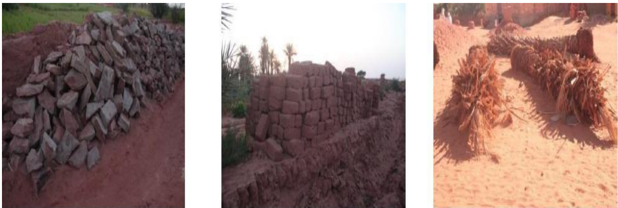
Figure 58 : Les matériaux de construction utilisés au niveau de village.
