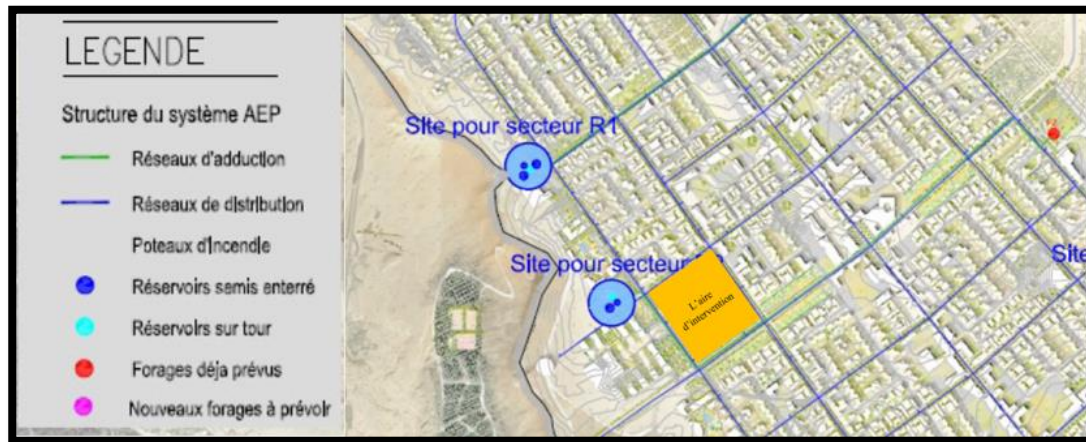
Figure 26: Situation de réservoir Source : Egis 2015, traité par les auteurs
