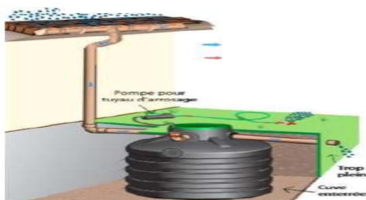
Figure 85 : système de récupération des eaux
