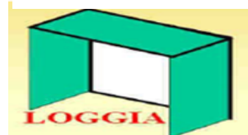
Figure 31 : protection solaire type loggia. Source : BELKACEM Nefissa
