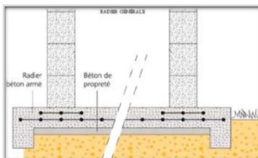
Figure N°= 59: Les fondations en radier Source : Google image.
