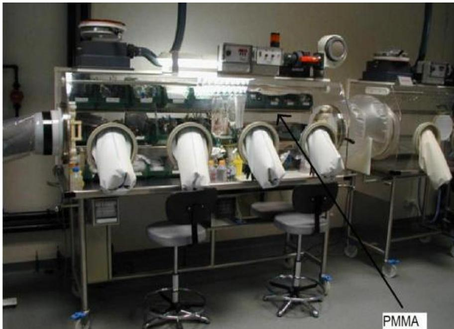
Figure 18 : Photo d'isolateur en plastique rigide
