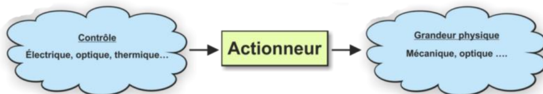
Figure 7 - Représentation schématique d'un actionneur
