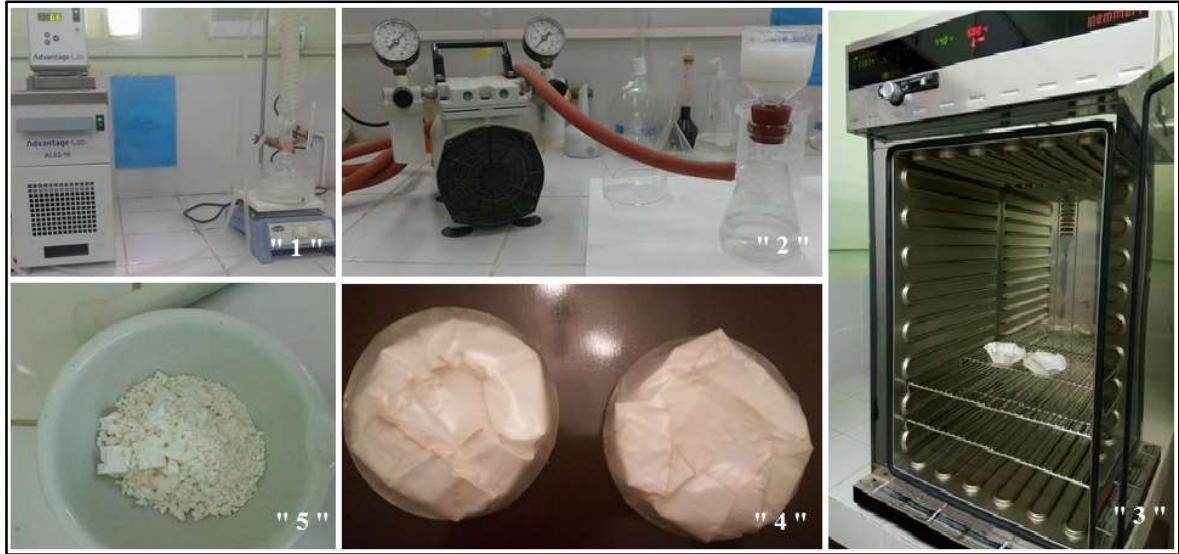
Figure 32 : Les différentes étapes de réticulation de l'amidon de maïs natif.
