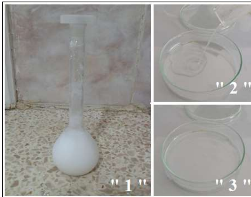
Figure 29. Préparation du Patch : « 1 » le mélange primaire avec les bulles, « 2 » versement de la préparation après 24h dans une boîte à pétri, « 3 » la préparation avant de devenir un patch de consistance semi-solide.
