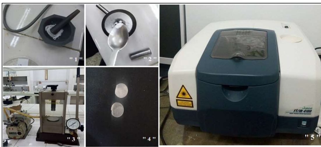
Figure 28 : Préparation des pastilles et spectrophotomètre utilisé.
