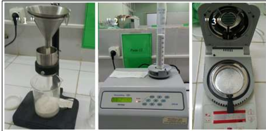
Figure 35. Les tests pharmacotechniques : « 1 » Ecoulement, « 2 » Tassement, « 3 » Mesure du taux de l'humidité résiduelle.
