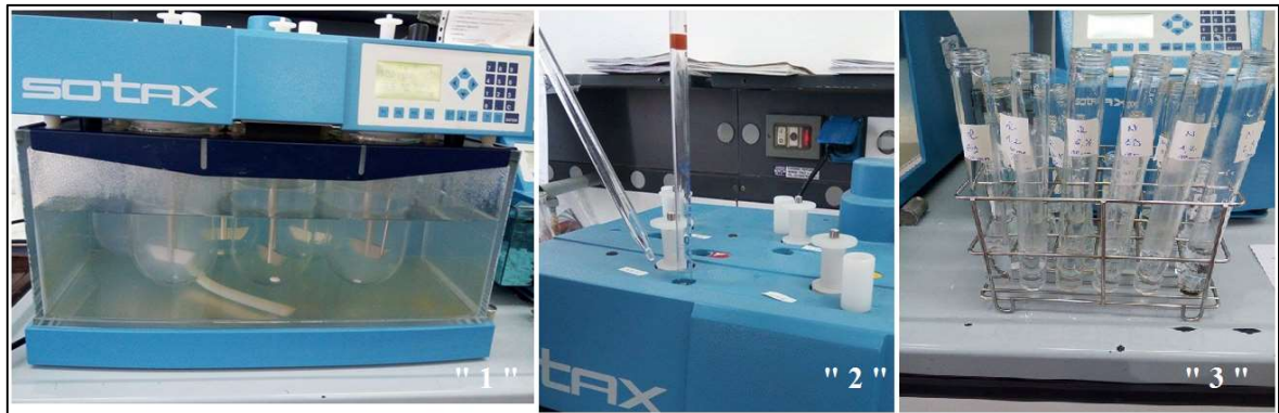
Figure 37. La dissolution des comprimés dans le dissolvent : « 1 » la dissolution, « 2 » prélèvement et remplacement du volume prélevé, « 3 » les volumes prélevés.
