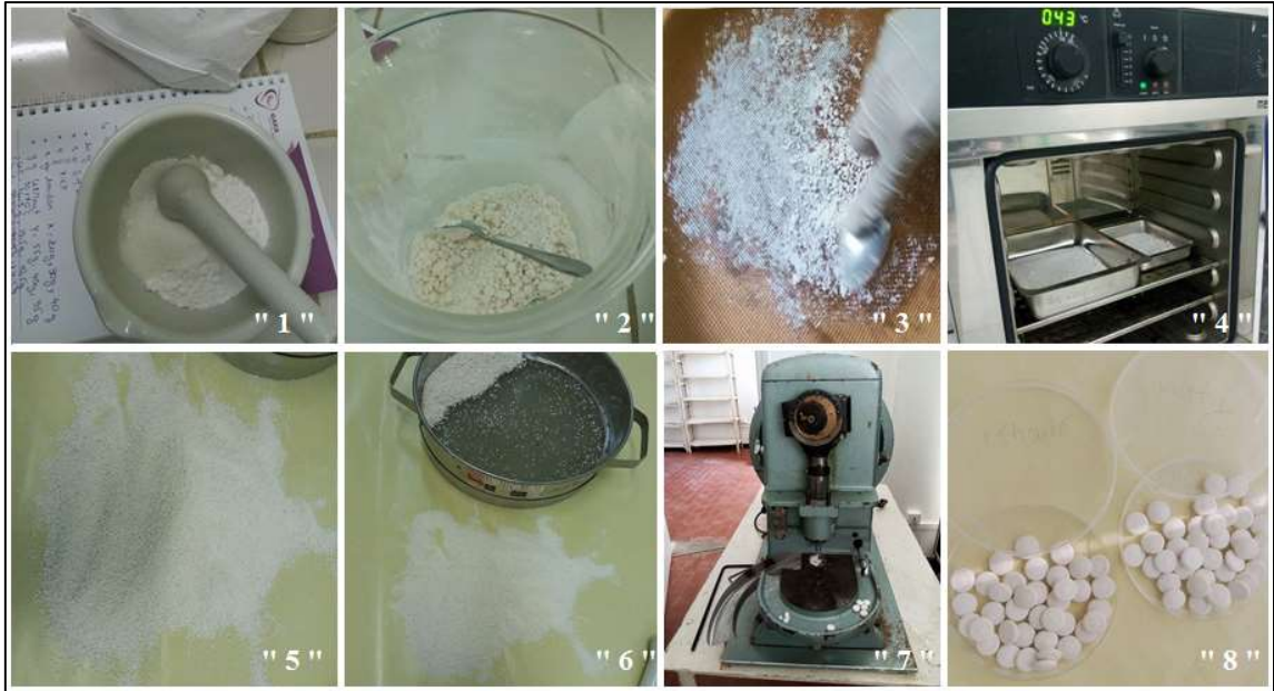
Figure 34. Les différentes étapes de la formulation des comprimés : « 1 » mélange des poudres, « 2, 3, 4, 5, 6 » granulation par voie humide, « 7, 8 » compression et obtention des comprimés.
