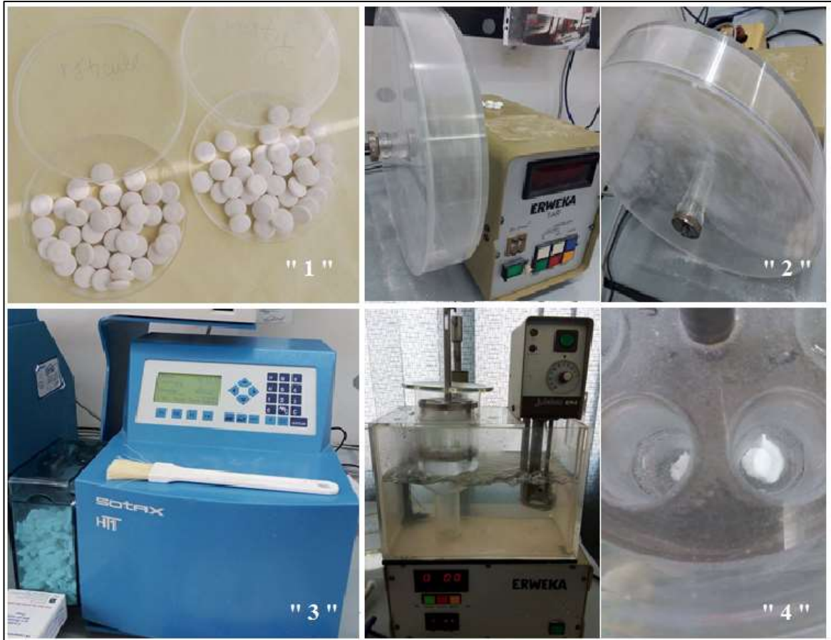
Figure 36. Les différents tests sur le produit fini : « 1 » Inspection visuelle, « 2 » Friabilité, « 3 » Dureté, « 4 » Désagrégation.
