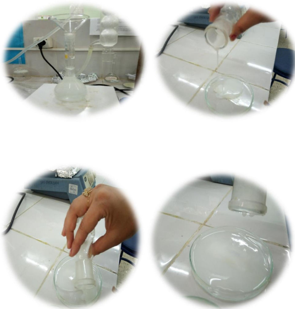
Figure IV.4: Préparation du patch: « 1 » le mélange primaire avec les bulles, « 2 » versement de la préparation dans une boîte à pétri, « 3 » la préparation avant de devenir un patch de consistance semi-solide.
