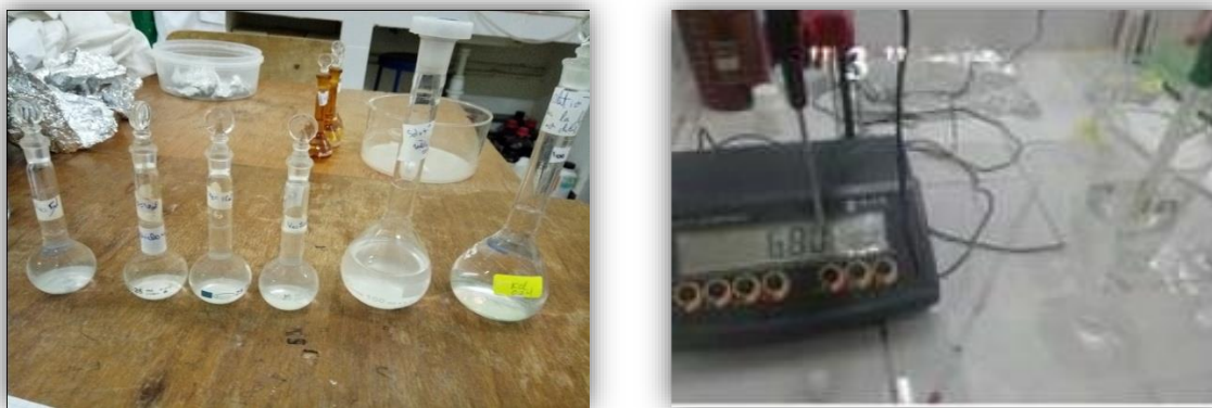
Figure IV.7: Les différentes étapes de préparations des solutions tampons : « 1 » les différentes solutions précurseurs de solution tampon, « 2 » Solution tampon à pH=6,8.
