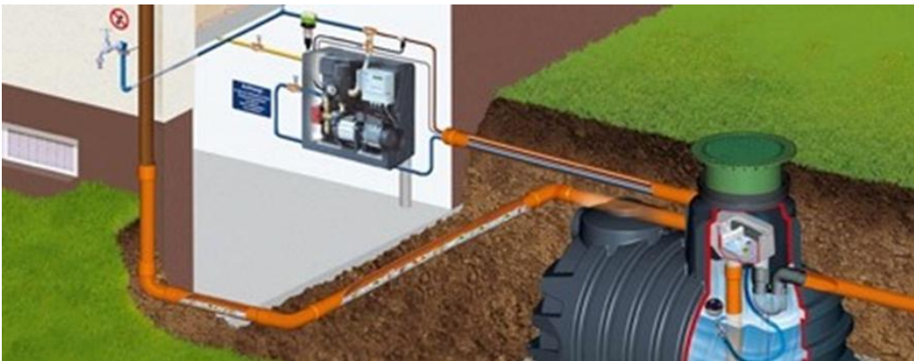
Figure 34 : Système de récupération de l'eau de pluie
