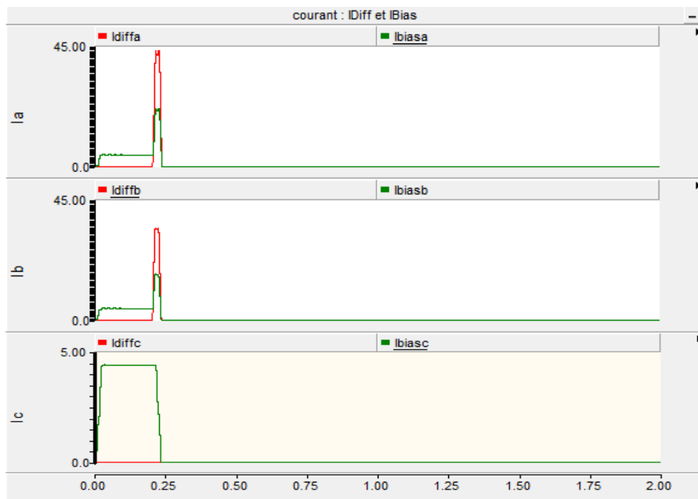
b). Formes des courants I_{Diff} et I_{Bias} des trois Phases.
