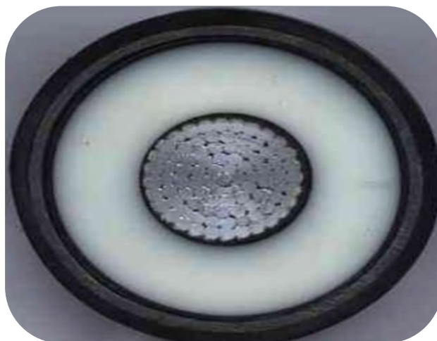
Figure 1.10: Câble électrique haute tension.
