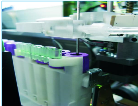
Figure 27 : Injection des échantillons hémolysés par aspiration.
