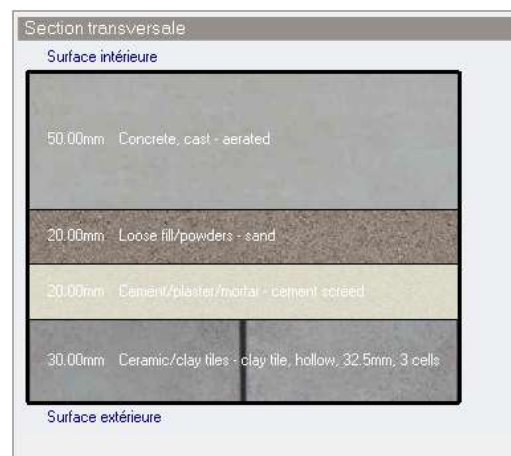
Fig. 17 Coupe sur plancher bas sur terrain
