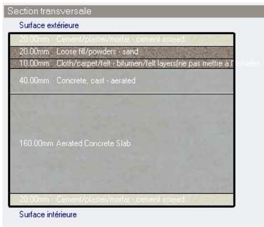
Fig. 16 .Coupe sur plancher 16+4
