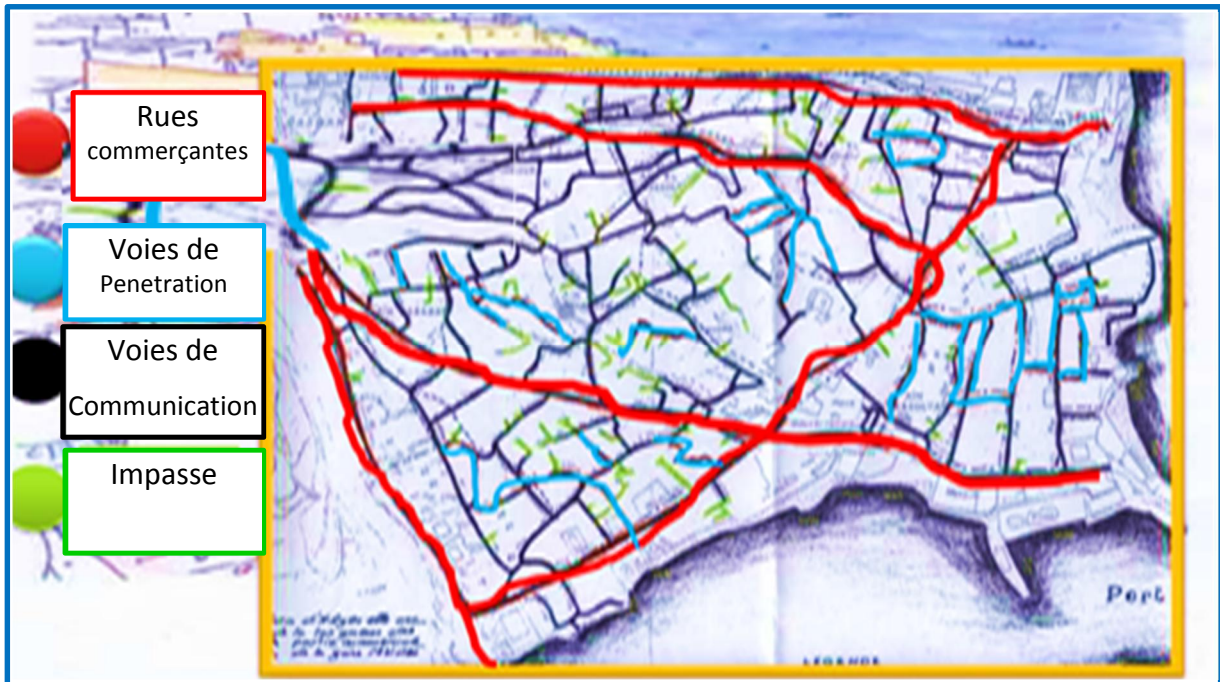
Figure 14 hiérarchisation du système viaire de la Casbah d'Alger. Source : GAMAR. h, FEKIH. M, mémoire de master, chronologie et typologie de la casbah d'Alger. Université Mohamed Kheider Biskra
