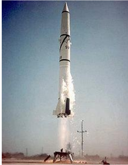
Figure 2.3 : Missile Redstone utilisant comme comburant le Peroxyde d'hydrogène
