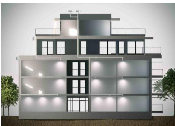
FigureII.11 : Schéma de principe de conception et fonctionnement d'une conduite de lumière naturelle
