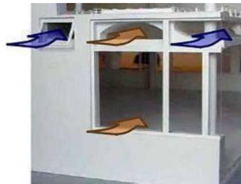
FigureII.3 : Dalle active par ventilation
