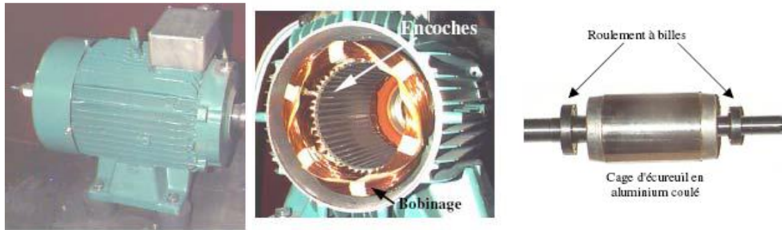
Figure 1.1 Machine asynchrone avec ces différentes composantes (Stator et rotor)
