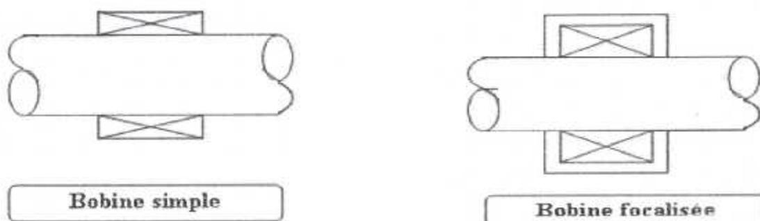
Figure 1.9 différents types de bobines [9]
