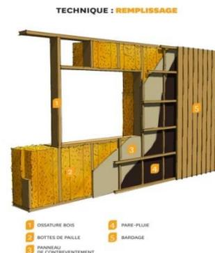
**Figure N°173** les couches du mur en paille
