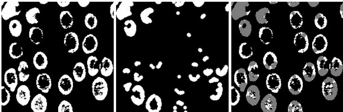
figure 3.9. – Exemple d'ouverture binaire (de gauche à droite : image initiale, ouverture par un disque de taille 3, différence : en blanc, les parties supprimées par l'ouverture).
