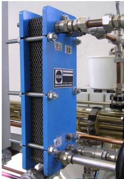
**Figure 2.12 : Echangeur à plaques**
