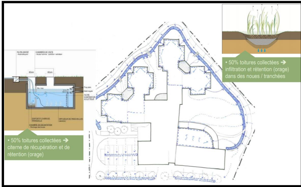
Figure N° 55 : Les dispositifs de récupération et d'infiltration d'eau pluviale
