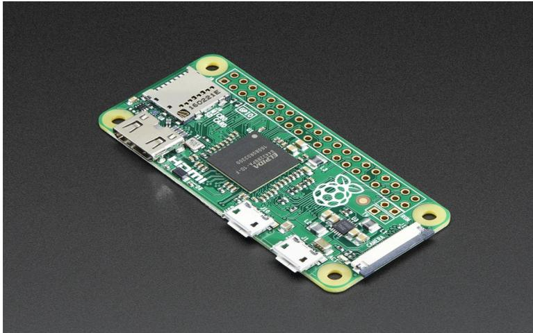
C'est le plus fin, le plus réduit Raspberry Pi à ce jour. C'est un peu comme le petit cousin du Pi, avec juste une fente pour carte micro SD, un port mini HDMI, deux ports micro USB (un pour l'alimentation, un pour USB) et 512 Mo de RAM. Il a une puce de processeur 1 GHz unipolaire, similaire aux Pi A + et B +.
