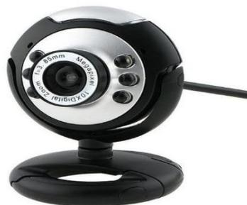
La camera web SKYMAX est une petite caméra vidéo qui alimente ou diffuse son image en temps réel vers ou via un ordinateur vers un réseau informatique, le flux vidéo capture peut être sauvegarde, visualise ou envoyé a d'autre réseau via des systèmes tels que l'internet, la camera web est généralement connectée par un câble USB, ou un câble similaire ou elles sont intégré dans un matérielles informatiques tels que les ordinateurs portables
