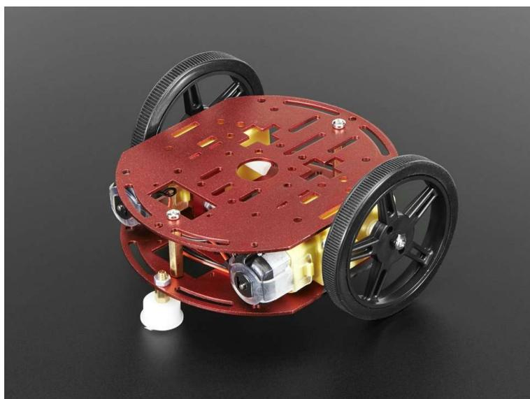
Ce kit de châssis à deux roues en métal avec moteurs à courant continu vous fournit un cadre de châssis en métal de haute qualité avec deux moteurs à courant continu, des roues et roulette, ainsi qu'une plaque métallique supérieure avec le matériel de montage.
