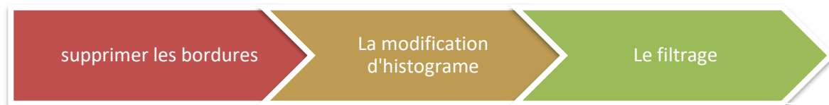
Figure 4. 2. Schéma synoptique du prétraitement.
