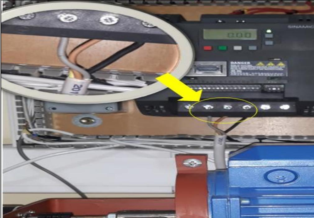
Figure IV.4. Raccordement du variateur de vitesse avec le moteur
