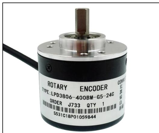
Figure I.17. L'encodeur incrémental LPD3806-400BM-G5-24C.
