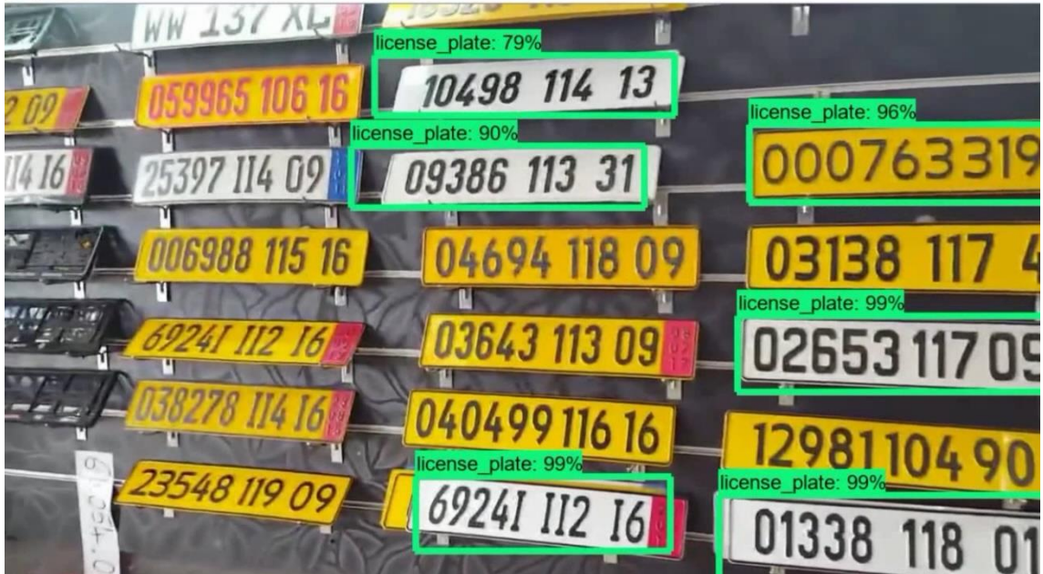
Figure 3-36 : Une image avec des plaques d'immatriculation détecté avec SSD MobileNet
