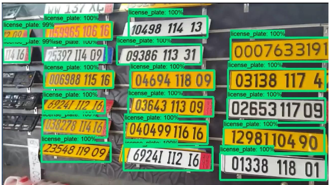
Figure 3-37 : Une image avec des plaques d'immatriculation détecté avec Faster R-CNN Inception v2.
