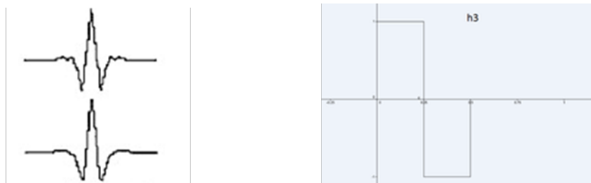
Figure 2.6. Ondelette Biorthogonal (gauche), Ondelette de Haar (droite).
