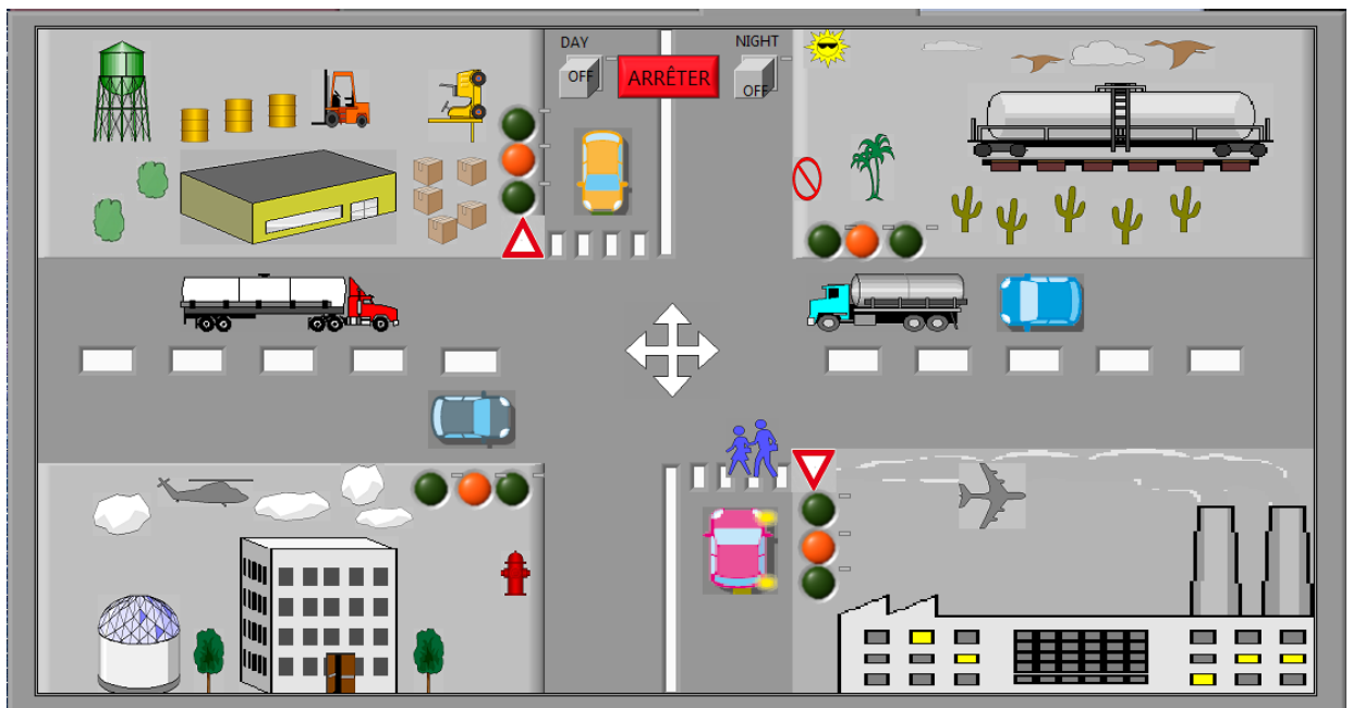
Figure 3.12. Supervision des feux rouges en mode nuit
