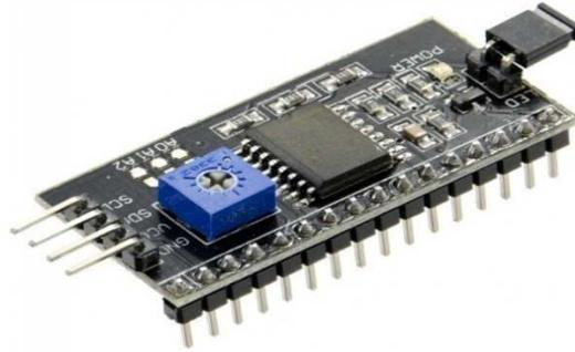
Figure 3.13 : Module d'interface I2C.
