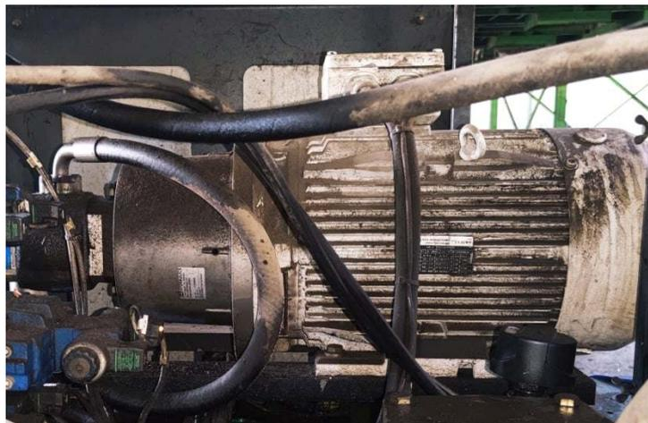
Figure III.8. Moteur de central hydraulique.
