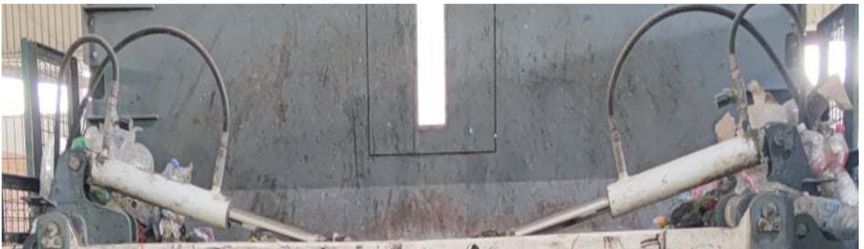
**Figure.III.6.** Les vérins des portes de remplissages.
