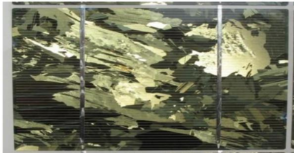
**Photo 2-3 :** Une cellule photovoltaïque à base de silicium multi cristallin [18]
