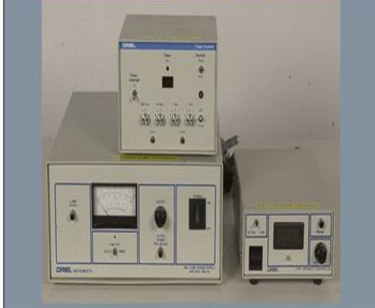
**Photo 2.5** Simulateur solaire classe A Oriel
