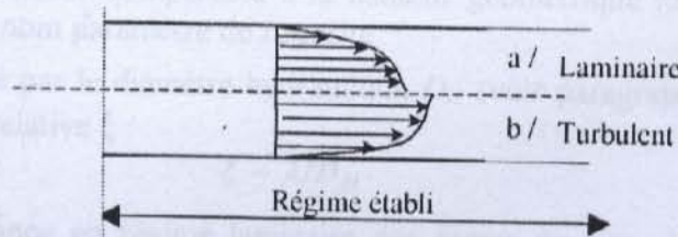
Figure (I-2 a, b) : Répartition des vitesses dans une section droite d'une conduite (régime laminaire 'a' et turbulent 'b') dans la zone établie
