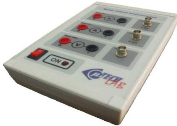
**Figure 3.3.**Capteur MCV3 de courant et tension
