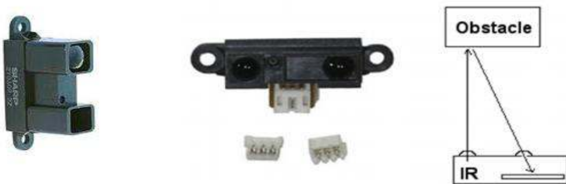
Figure 3.13: Principe du télémètre infrarouge à triangulation et exemple de télémètre réel
