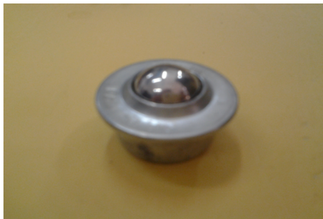
Figure2.6: Roue bille en avant pour la stabilité de robot mobile
