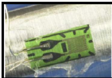
FigureII.5: Collage d'une jauge de contrainte sur un axe
