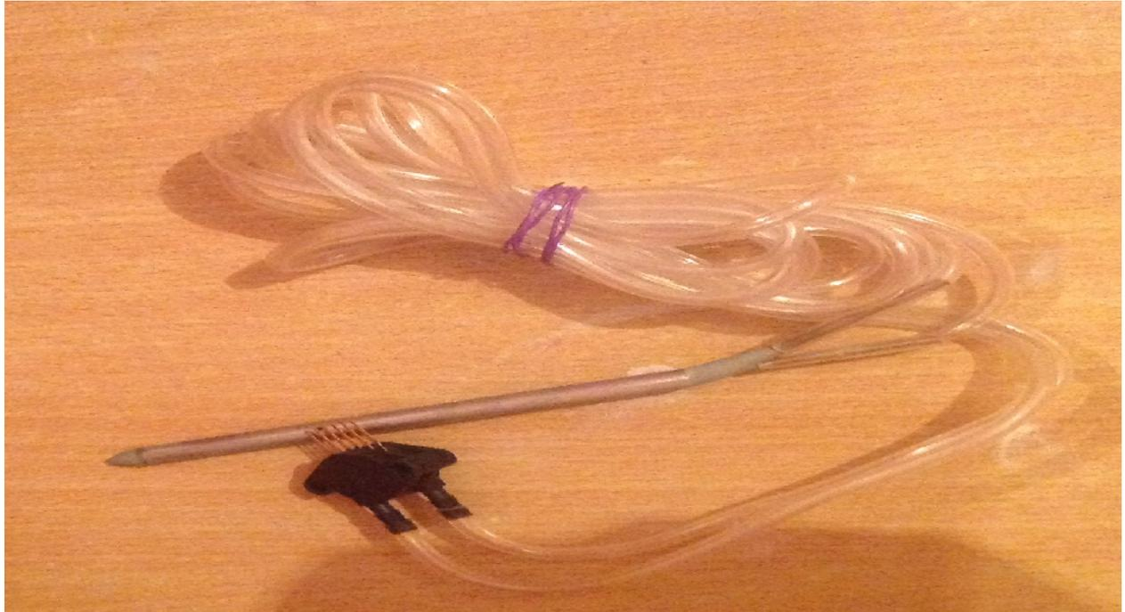
Figure III.15 :le capteur de pression avec tube de pitot
