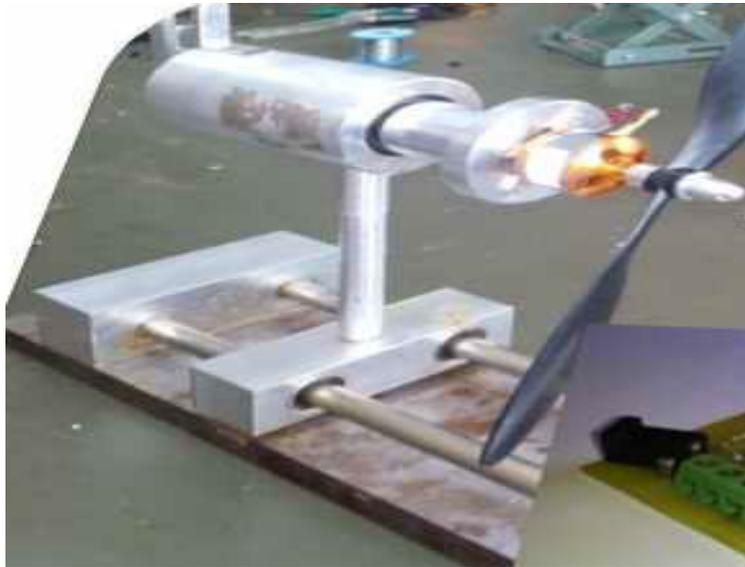
Figure III.1 : banc d'essai moteur Brushless
