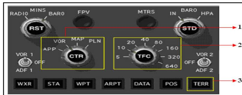
Figure 2.7 : Le panneau du contrôle EFIS
