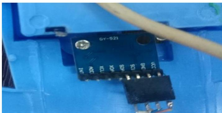
Figure 4.7 : Les pins utilisée dans le MPU 6050
