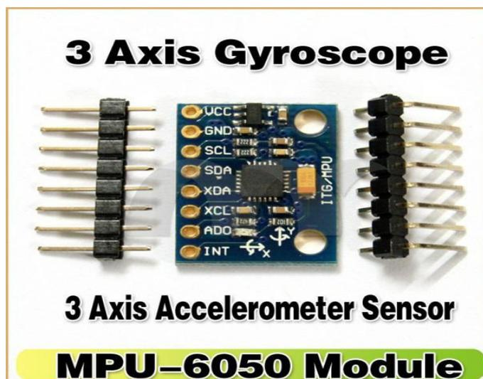
Figure 3.11 : Le module MPU 6050
