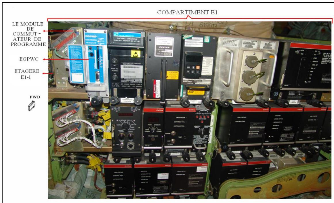
Figure 2.8 : Emplacement de l'EGPWC et du PIN Program
