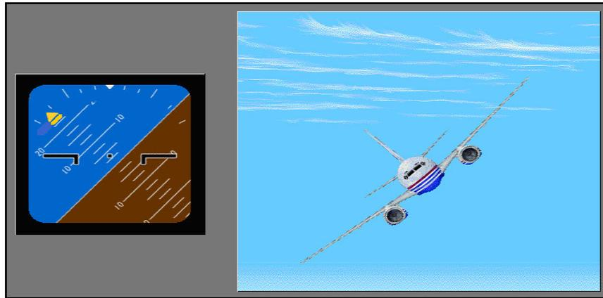
Figure 2.21: Inclinaison de l'avion dépasse  $45^\circ$
